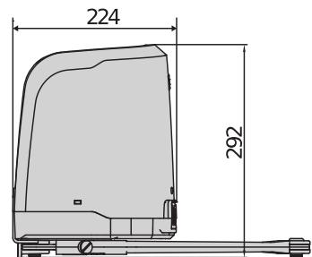
Azami 2 metre genişliğinde ve 200 kg ağırlığındaki kanatlı bahçe kapıları için uygun, mesken tipi kullanıma yönelik mafsallı kolu elektromekanik operatör.
