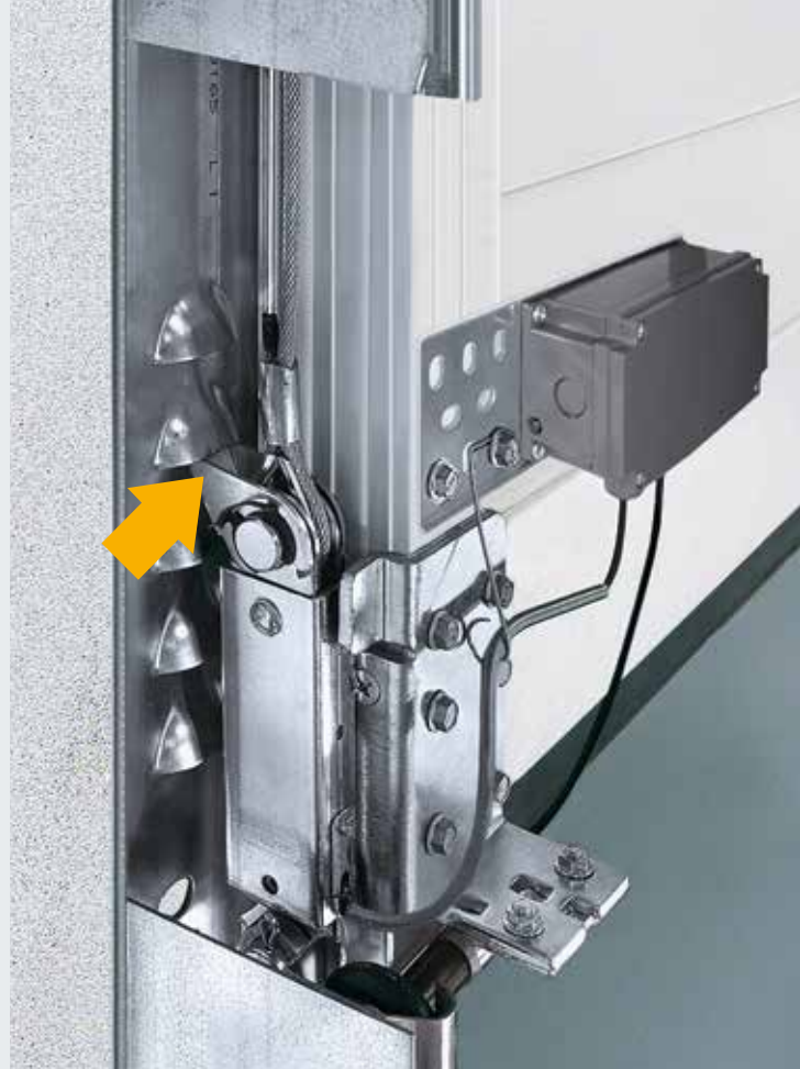
Kapı yukarı doğru zorlanırsa açılma emniyetinin dili otomatik olarak oturur ve hareketi önler.
